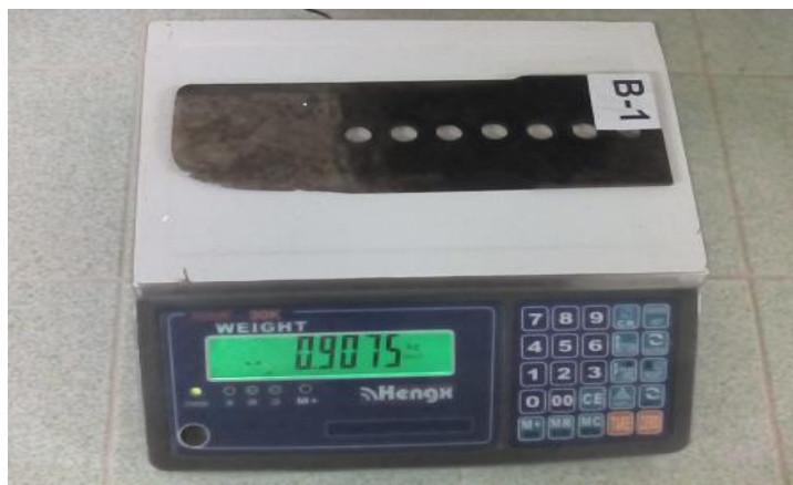
FIGURA 2. Balanza digital utilizada en el ensayo de desgaste.
