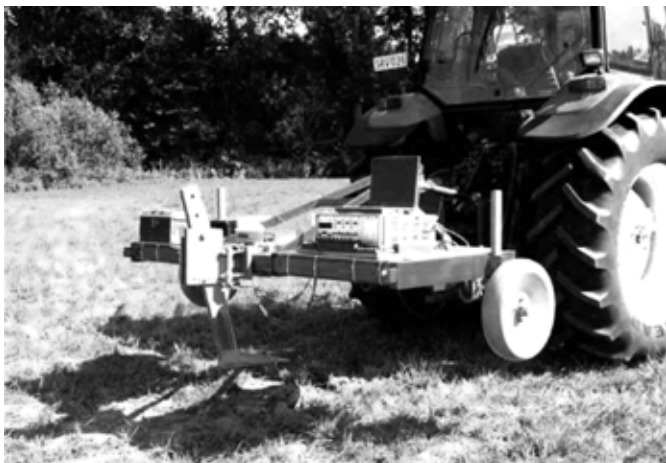
FIGURA 2. Sensor que posee una celda de carga que trabaja como una viga en cantiléver, (Mouazen et al. , 2003a).
