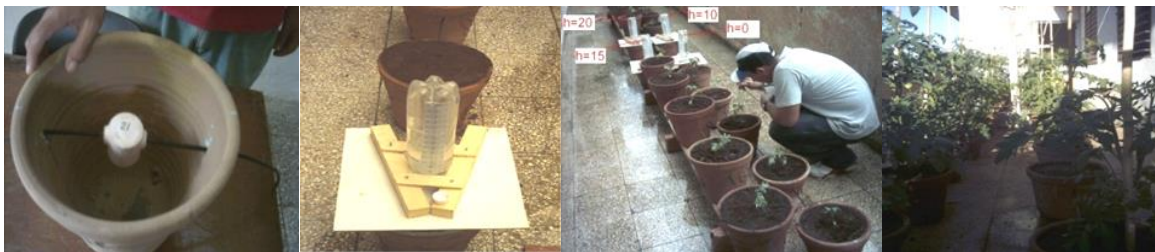
FIGURA 2. Secuencia de montaje del experimento en condiciones controladas: De izquierda a derecha: Colocación de cápsulas en las macetas; dispositivo de medición del volumen de agua consumido; vista del montaje del experimento y cultivo en fase de crecimiento: Fuente: Elaboración propia de los autores.
