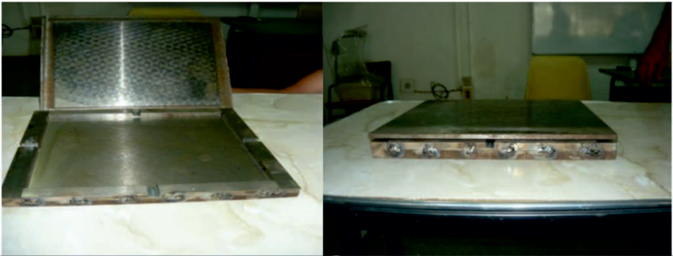
FIGURE 5. Mold Used for Manufacture of Composite Materials FIGURA 5. Molde empleado para fabricación de los materiales compuestos.
