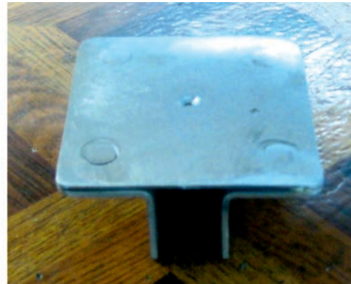
FIGURE 4. Sketch of specimen for Bond Strength by Load Test and the Device with Chamfer Hole FIGURA 4. Probeta del ensayo de desprendimiento de fibra por tensión y el dispositivo con agujero biselado.
