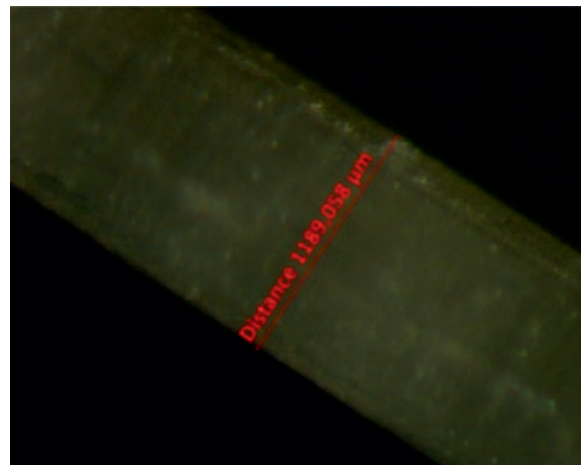
FIGURE 3. Measuring the diameter of the henequen fibre. FIGURA 3. Medición del diámetro de la fibra de henequén.
