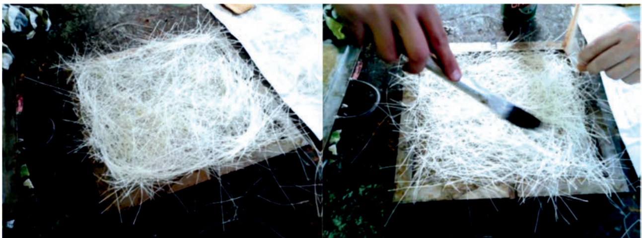
FIGURE 6. Placement and impregnating the fibers with the resin into the mold. FIGURA 6. Colocación e impregnación de las fibras con la resina en el molde.
