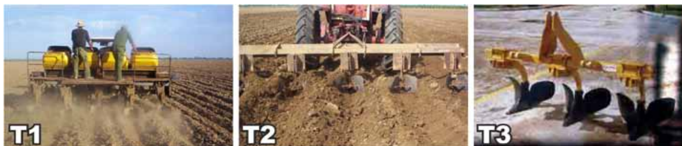
FIGURA 1. Tratamientos evaluados en la labor de surcado: T1- Tractor MTZ-50 y Surcador Fertilizador IIMA-BALDAN 4500; T2- Tractor MTZ-50 y Surcador Aporcador SA-5; T3- Tractor MTZ-50 y Surcador Aporcador SA-3 (NC 3463: 88; NC 3449: 03; NRAG XXI: 2005).
