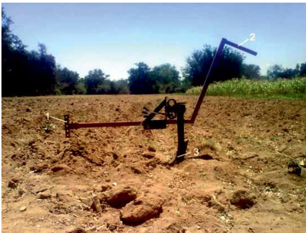
FIGURA 1. Arado de tracción animal desarrollado en CIIDIR, Oaxaca, México.
