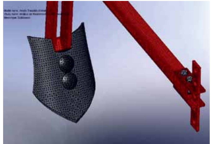
FIGURA 3. Mallado paramétrico arado FDN.
