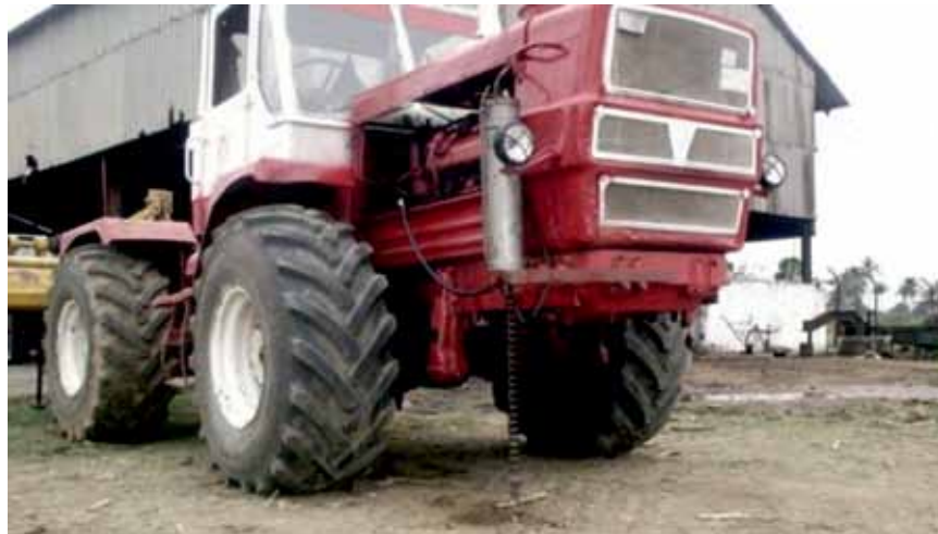
FIGURA 1. Depósito aforado para determinar consumo de combustible.
