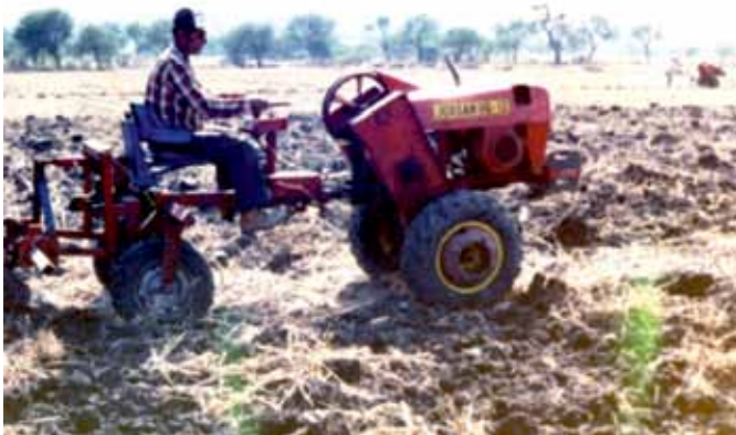
FIGURA 5. Motocultor alto despeje vista lateral. Fuente Lara (2000).
