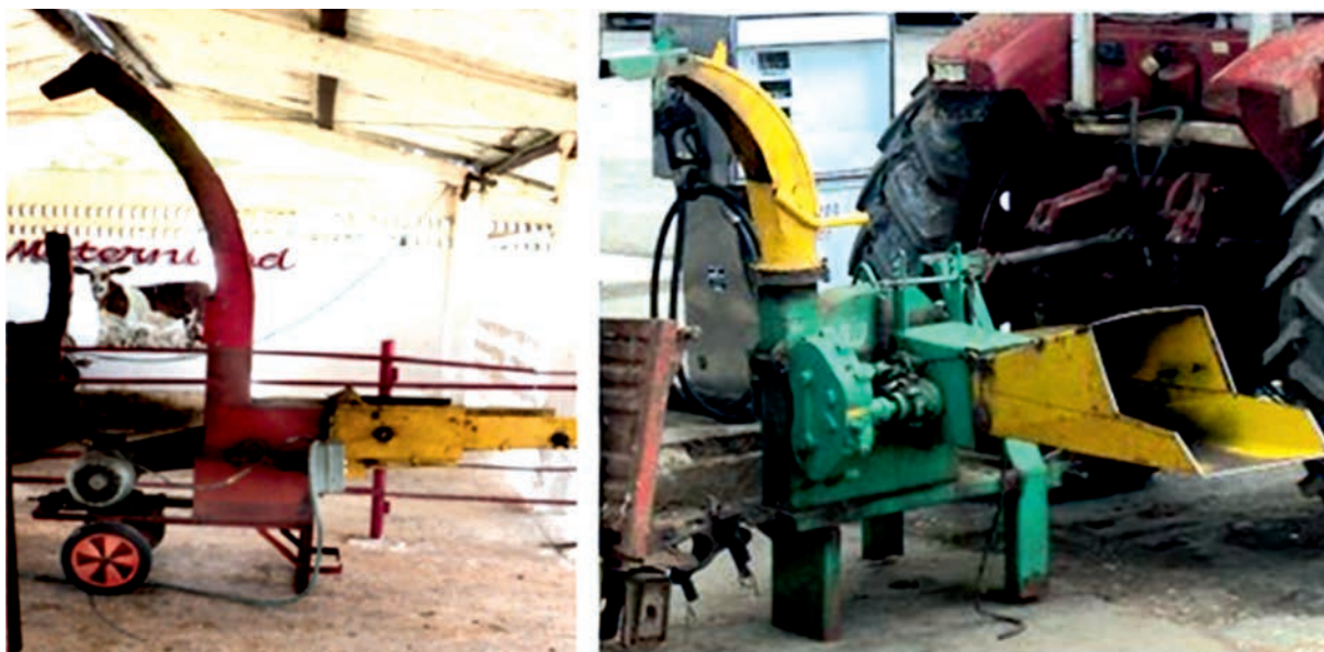
FIGURE 1. Forage chopper machines evaluated a) MF IIMA model EM-01 perfected b) JF-50. FIGURA 1. Picadoras de forraje evaluadas, a) MF IIMA modelo EM-01 perfeccionada b) JF-50.
