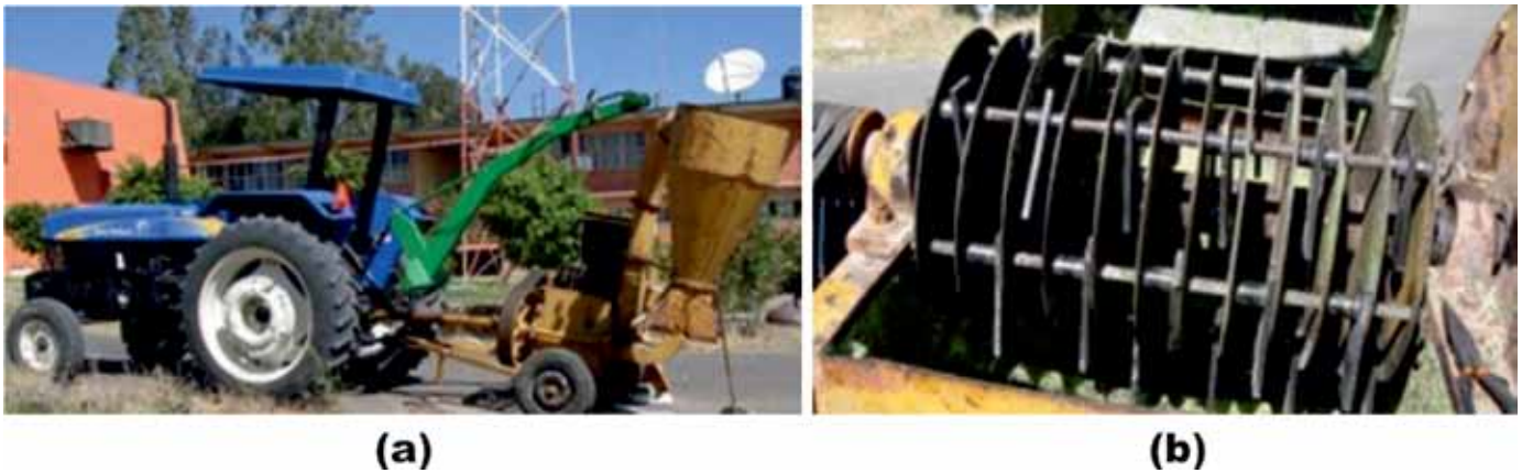
FIGURA 1. Molino de martillos; (a) vista general del equipo; (b) tambor rotativo.
