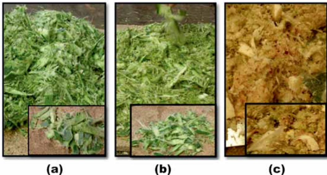
FIGURA 5. Material troceado a 1500 rpm; (a) hojas a 45°; (b) hojas a 90°; (c) piña.
