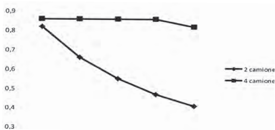
FIGURA 3 Comportamiento del coeficiente de utilización del tiempo de la cosechadora. FIGURE 3. Behavior of the time utilization coefficient of the harvester machine.
