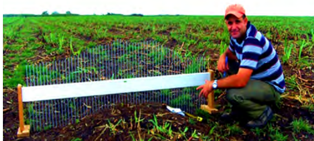
FIGURA 1. Perfilómetro de varillas construido.
