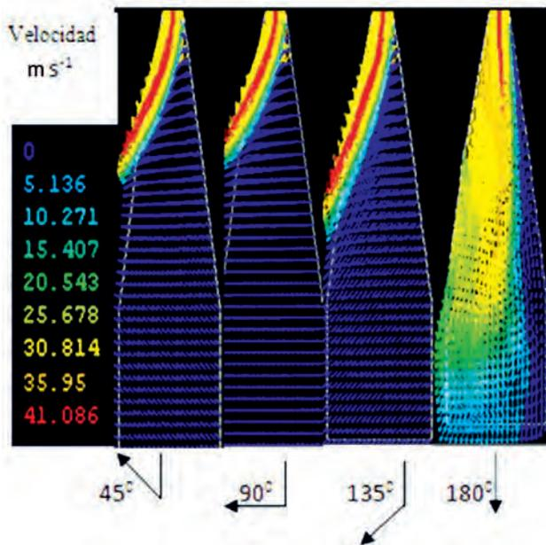
FIGURA 3. Flujo de aire del pulverizador con velocidad del viento 5 m·s<sup>-1</sup> y dirección de 45°, 90°, 135° y 180°.
