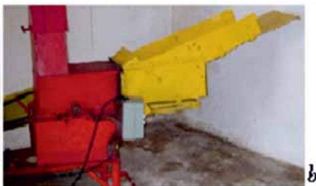
FIGURA 3. a) Rampa de alimentación diseñada, b) Acoplada a la picadora.
