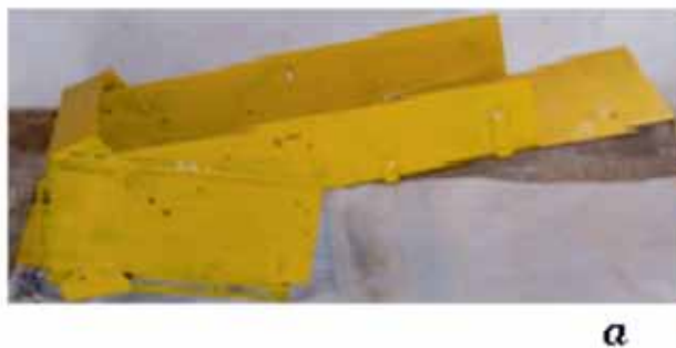
FIGURA 3. a) Rampa de alimentación diseñada, b) Acoplada a la picadora.
