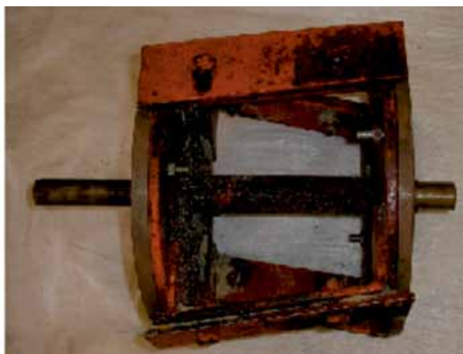
FIGURA 4. Platos laterales atornillados al tambor.
