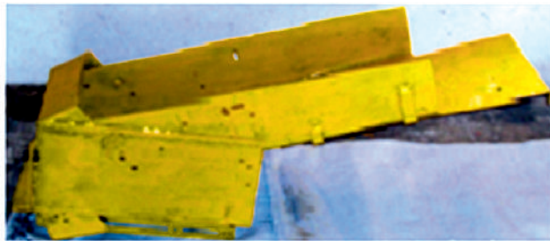
FIGURA 4. a) Rampa de alimentación diseñada, b) Acoplada a la picadora.
