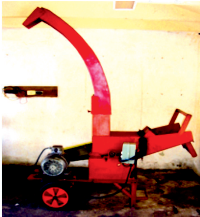
FIGURA 3. Vista general de la picadora original.
