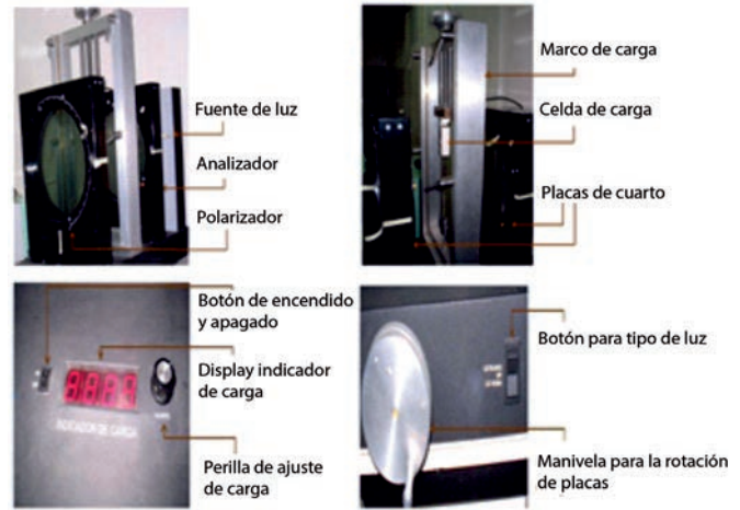
FIGURA 2. Componentes del polariscopio modelo SSM-AJ.
