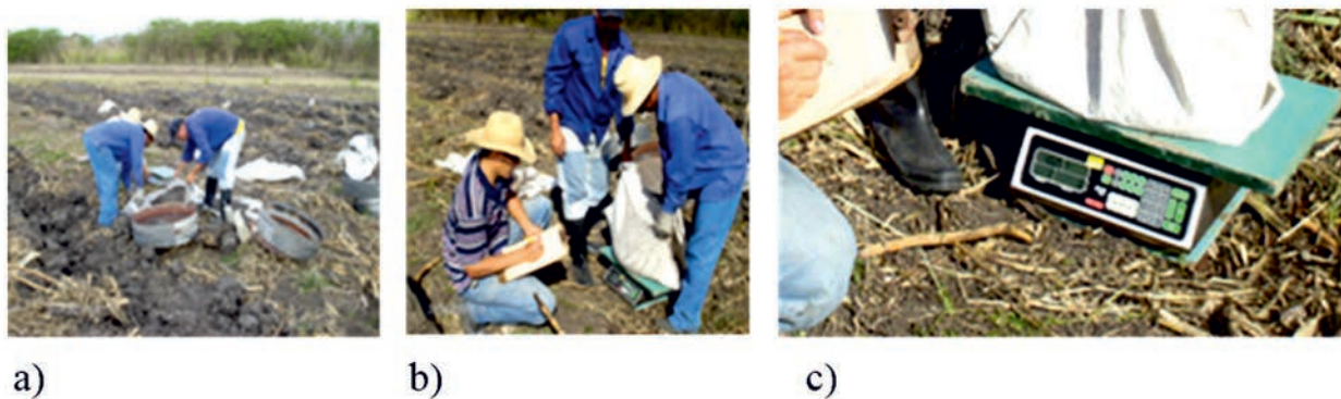
FIGURA 1. Determinación de la fragmentación del suelo. a). Separación de las partículas, b). Peso del suelo separado; c) Balanza digital empleada.
