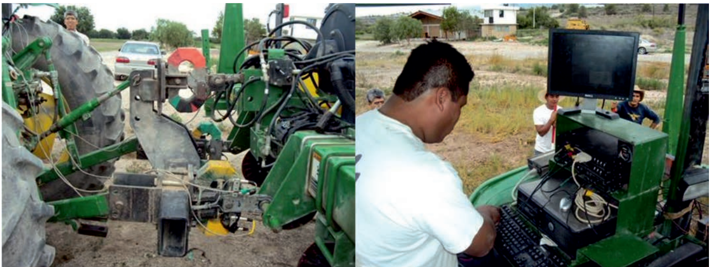
FIGURA 1. Conjunto de dinamómetro integral y sistema de adquisición de datos acoplados al tractor.
