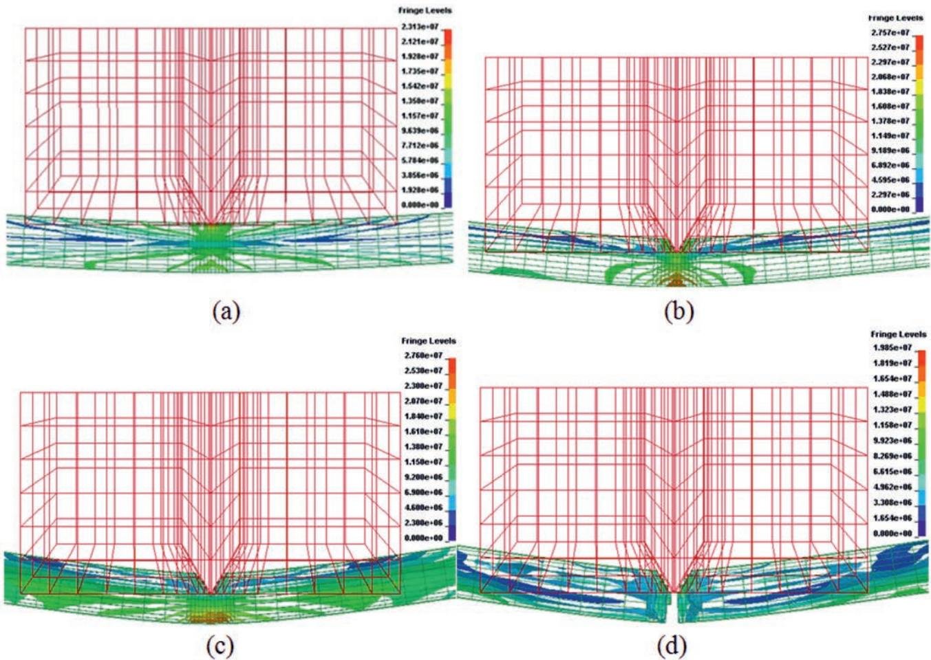
FIGURA 3. Esfuerzos de Von Mises (isosuperficies) durante el corte de la fibra de agave a; (a) 0,0097 s; (b) 0,0139 s; (c) 0,0157 s; (d) 0,0160.
