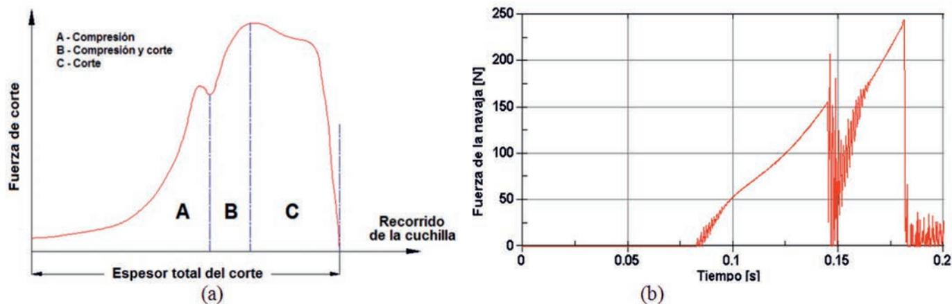
FIGURA 6. Fuerza de corte a lo largo del espesor de la fibra; (a) Srivastava (1993) citado por Ledesma et al. (2009); (b) Simulación.
