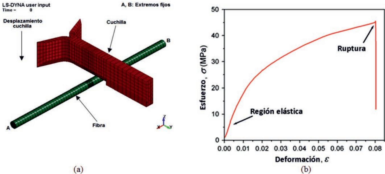
FIGURA 2. (a) Modelo de elemento finito, cuchilla-fibra; (b) curva esfuerzo-deformación típica para la fibra de *Agave tequilana* Weber (Kestur *et al.*, 2012).
