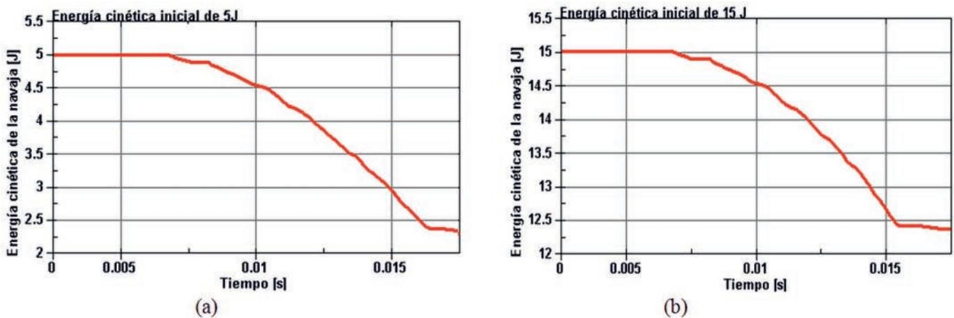
FIGURA 5. Energía cinética de la navaja durante el proceso de corte; (a) 5J; (b) 15 J
