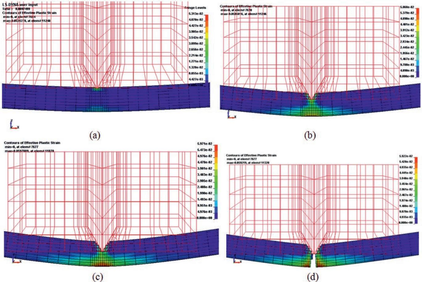
FIGURA 4. Deformación plástica durante el corte de la fibra de agave a; (a) 0,0097 s; (b) 0,0139 s; (c) 0,0157 s; (d) 0,0160.
