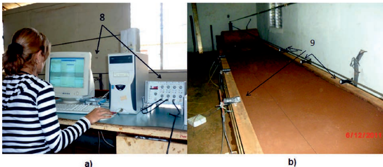
FIGURA 3. Instrumentación utilizada en la investigación, a) sistema dinámico de adquisición de datos; b) sistema laser-foto diodo.
