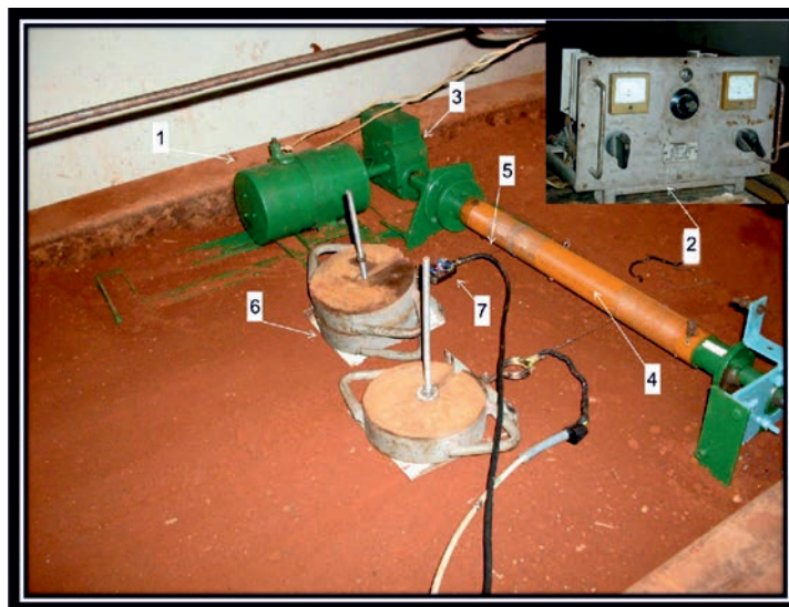
FIGURA 2. Maqueta experimental utilizada en la investigación: 1 -motor de corriente directa; 2 -fuente de voltaje de corriente directa; 3 -reductor de velocidad; 4 -tambor motriz, 5 -cable de masa despreciable; 6 -conjunto plancha metálica-masa calibrada; 7 -transductor de fuerza tipo S.
