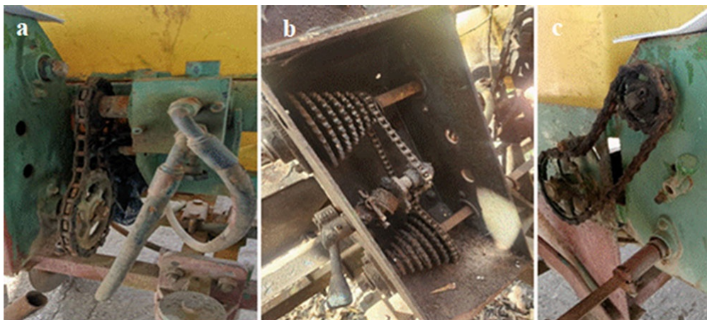
Figura 2. Hidromotor (a), Caja de velocidad (b) y transmisión al transportador sinfin (c)
