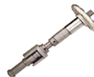
Figura 8. Cortador y biselador de tubo. Fuente: TECNOLOGIES (2007)
