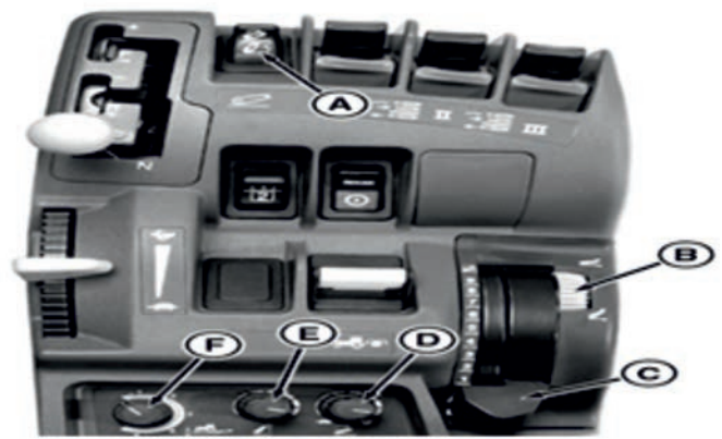
FIGURA 12. Vista de todo el panel de control. A-Control de elevación/descenso, B-Tope del mando del elevador, C-Palanca de control del elevador, D-Mando de velocidad de descenso, E-Mando limitador de altura, F-Mando de carga/profundidad
