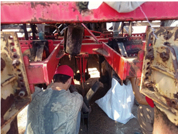
Figura 1. Posicionamiento de los sacos en los tubos de descarga de la fertilizadora FMCM-1.
