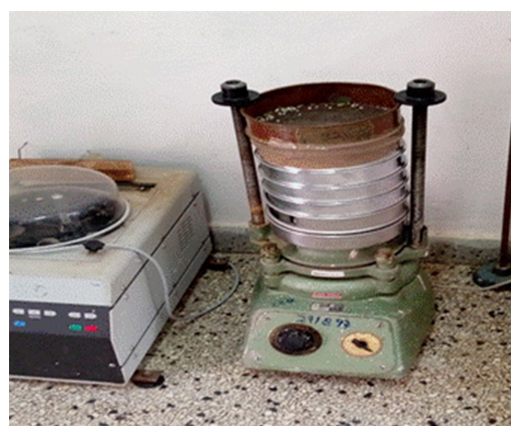
Figura 1. Vibrador de tamices utilizado para la determinación de la granulometría.
