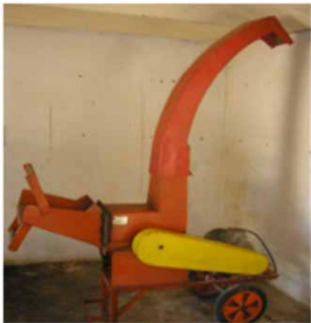
FIGURA 1. Picadora de forraje MF-IIMA Modelo EM-01.
