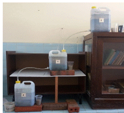
FIGURA 1. Filtros lentos de arena confeccionados.
