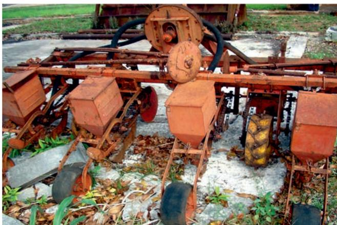
FIGURA 1. Máquina SUP-PN8 modificada para la siembra directa.
