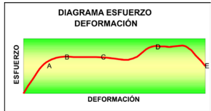
FIGURA 3. Diagrama esfuerzo-deformación de un cuerpo al aplicarle compresión.
