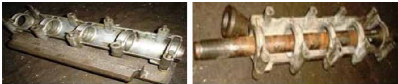
FIGURA 2. Dispositivo para la reparación del cuerpo del árbol de distribución de motor VAZ (Cortesía de Hugo Ranero).
