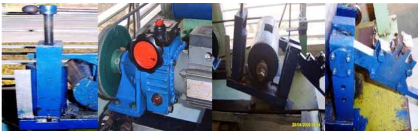
FIGURA 6. Componentes de las maquina de fricción de revoluciones (de izquierda a derecha): A. Captador inductivo B. Motovariador de velocidad. C. Bancada móvil. D. Brazo de la bancada.
