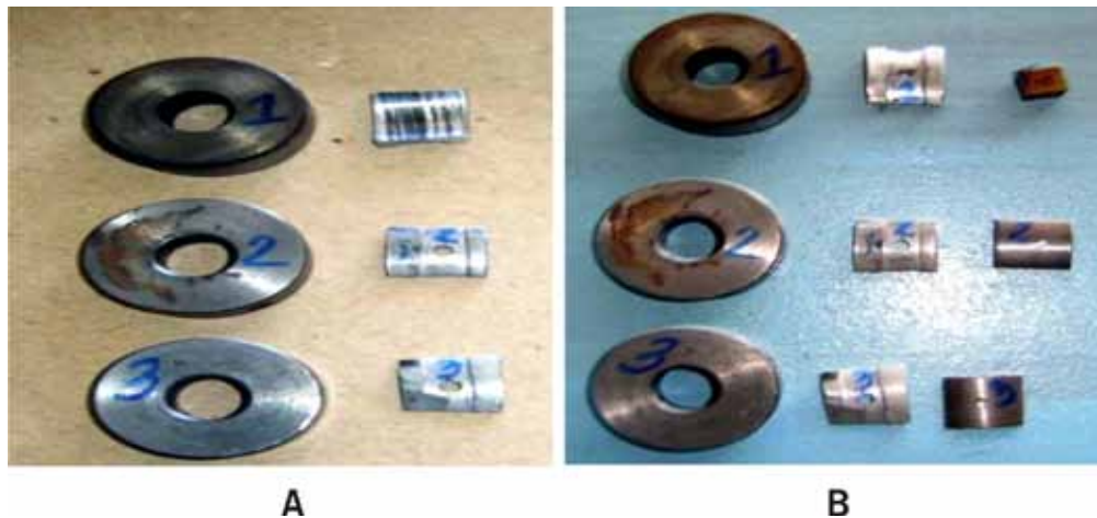
FIGURA 5. Probetas del cuerpo de alojamiento original o testigo (A) y del casquillo experimental recubierto con aleación Babbit B 83 (B).
