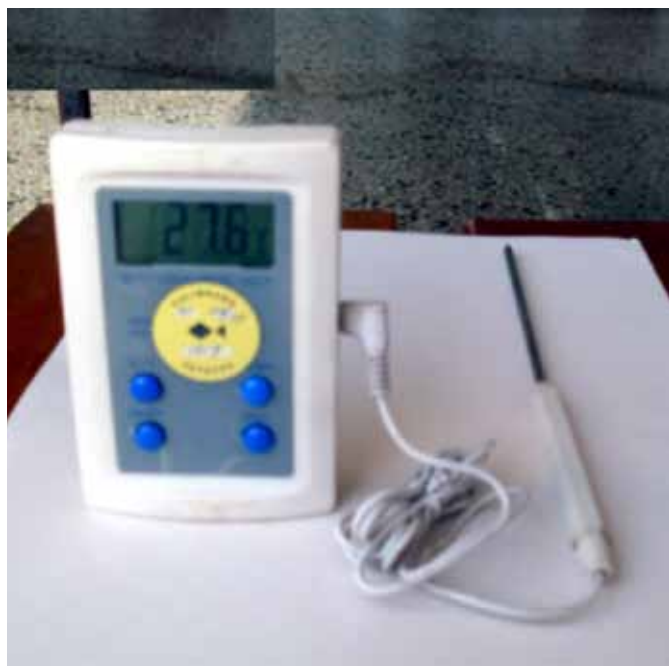
FIGURA 3. Termómetro digital para medir la temperatura ambiente.
