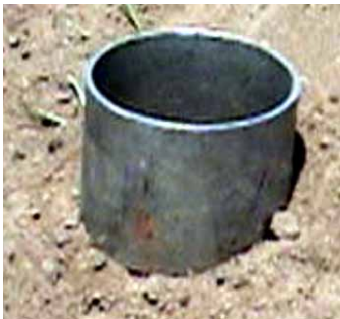
FIGURA 5. Cilindro para la determinación de la densidad aparente del suelo.
