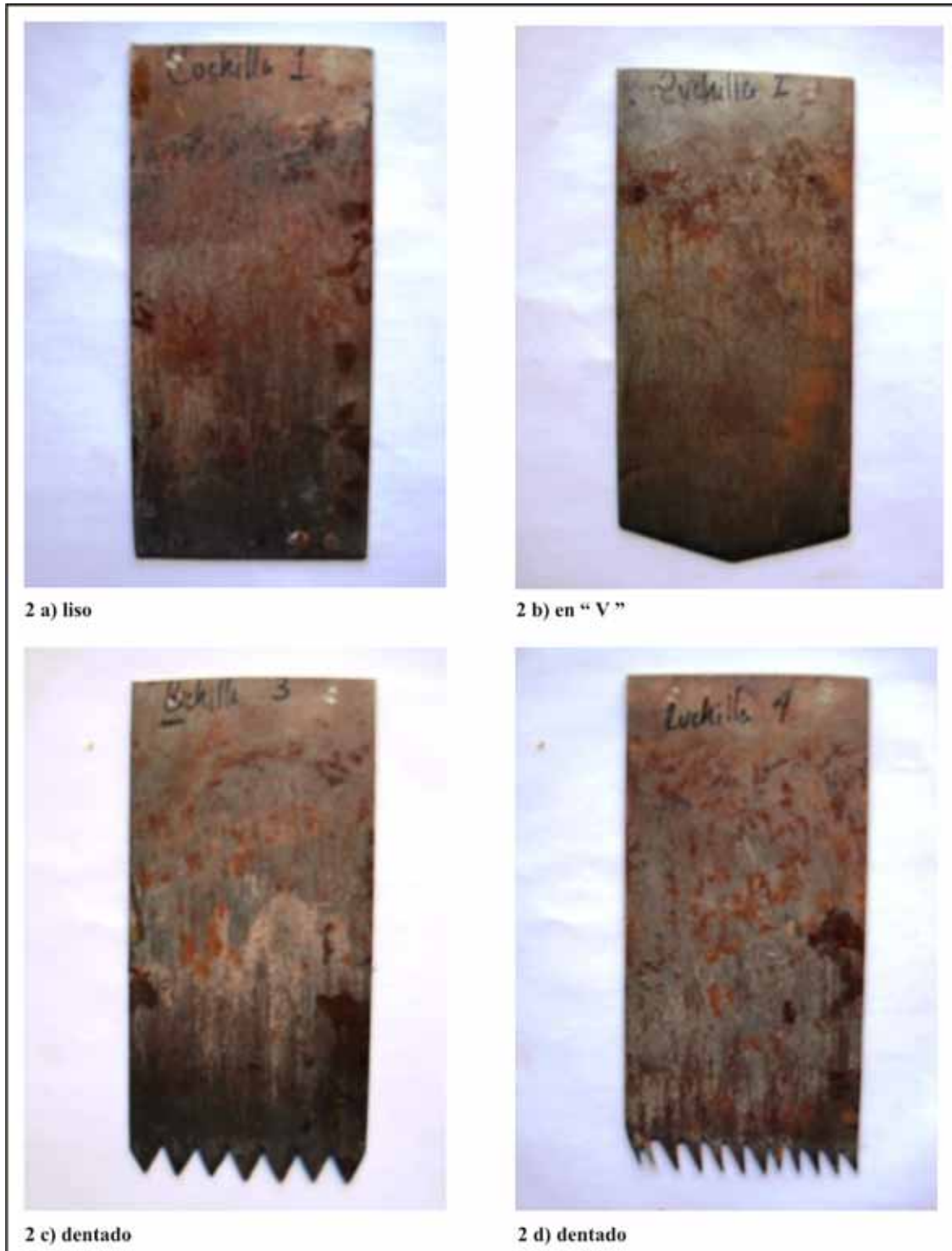
FIGURA 2. Formas del borde cortante de las cuchillas.
