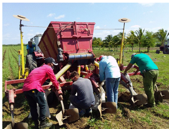
FIGURA 2. Obtención de la cantidad de abono distribuida por cada tubo de salida de la fertilizadora.
