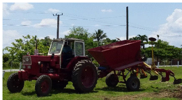
FIGURA 1. Fertilizador ID-David acoplado a un tractor UMZ.
