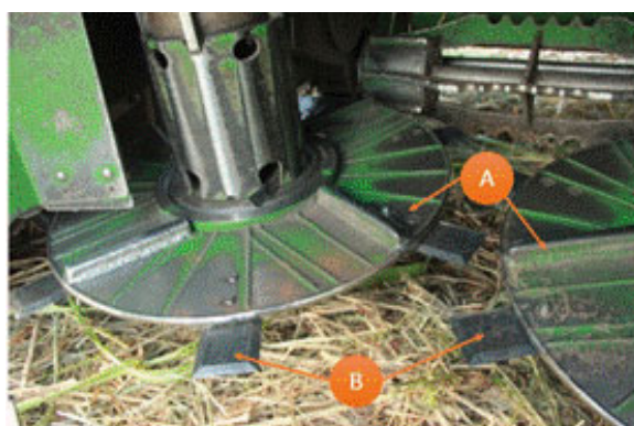
FIGURA 7. Cortador base de cosechadora John Deere 3522. Tomada de Ma et al. (2014) .
