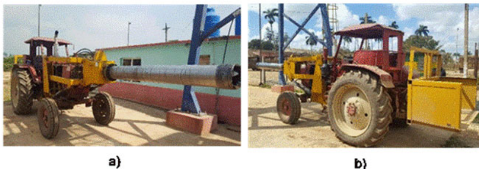
FIGURA 1. Sonda Toma muestra (a) y cesto (b) acoplados al tractor YUM-6.
