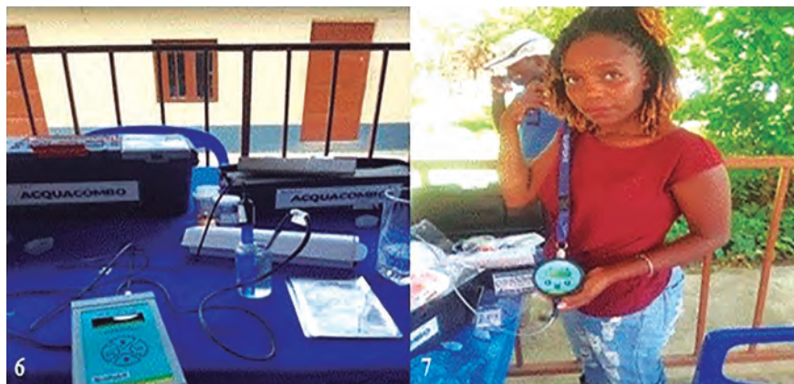
FIGURE 6-7. ACQUAcombo kit of water quality analysis for aquaculture from Alfakit used in the evaluation of physical (temperature and transparency) and chemical (dissolved Oxygen, Hydrogen potential and total ammonia) parameters of water quality in Tchissola II farm FIGURA 6-7. ACQUAcombo kit de análise de qualidade da água para aquicultura de Alfakit utilizado na avaliação de parâmetros físicos (temperatura e transparência) e químicos (Oxigênio dissolvido, potencial de Hidrogênio e amônia total) da qualidade da água na Fazenda Tchissola II
