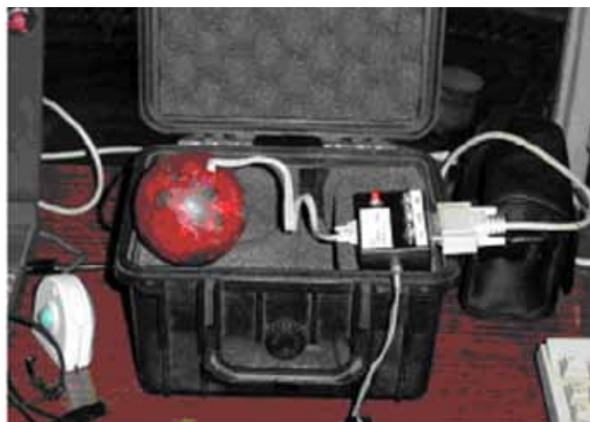
FIGURA 3. IS-100 o esfera instrumentada para el análisis de impactos en la recolección y manipulación de los productos agrícolas.
