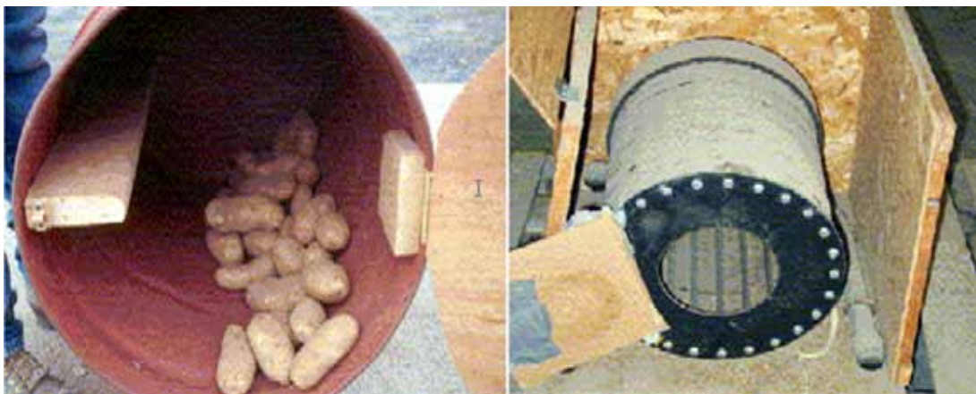
FIGURA 4. Ensayo de susceptibilidad a daños de las patata empleando tambores rotativo con distinto niveles de agresividad (altura de los obstáculos interiores). Fuente: Washington State University.
