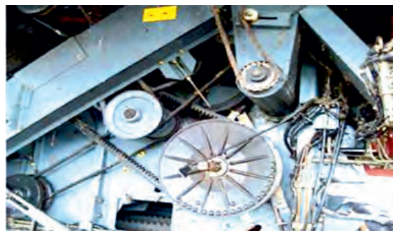
FIGURE 2. Transmission system of the maize combined Massey Ferguson. FIGURA 2. Sistema de transmisión de la cosechadora de maíz Massey Ferguson.
