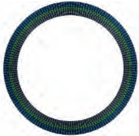
FIGURE 3. Sandwich pipe mesh. FIGURA 3. Malla del ducto compuesto.
