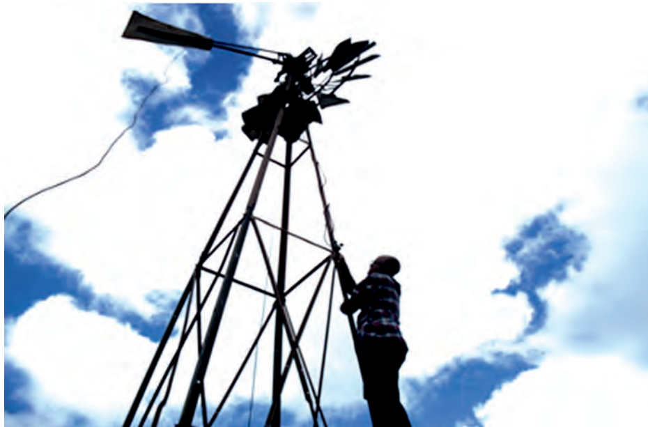
FIGURE 2. Multi-blade mill used in wind pumping. FIGURA 2. Molino multipala utilizado en el bombeo eólico.
