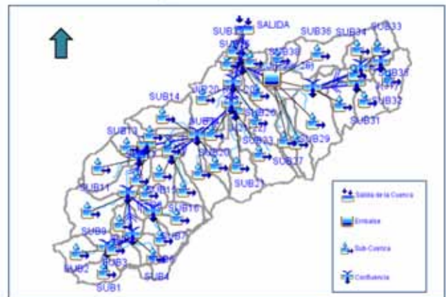
FIGURA 4. Modelo conceptual de la cuenca y subcuencas en HEC-HMS considerando el embalse “El Isiro”.
