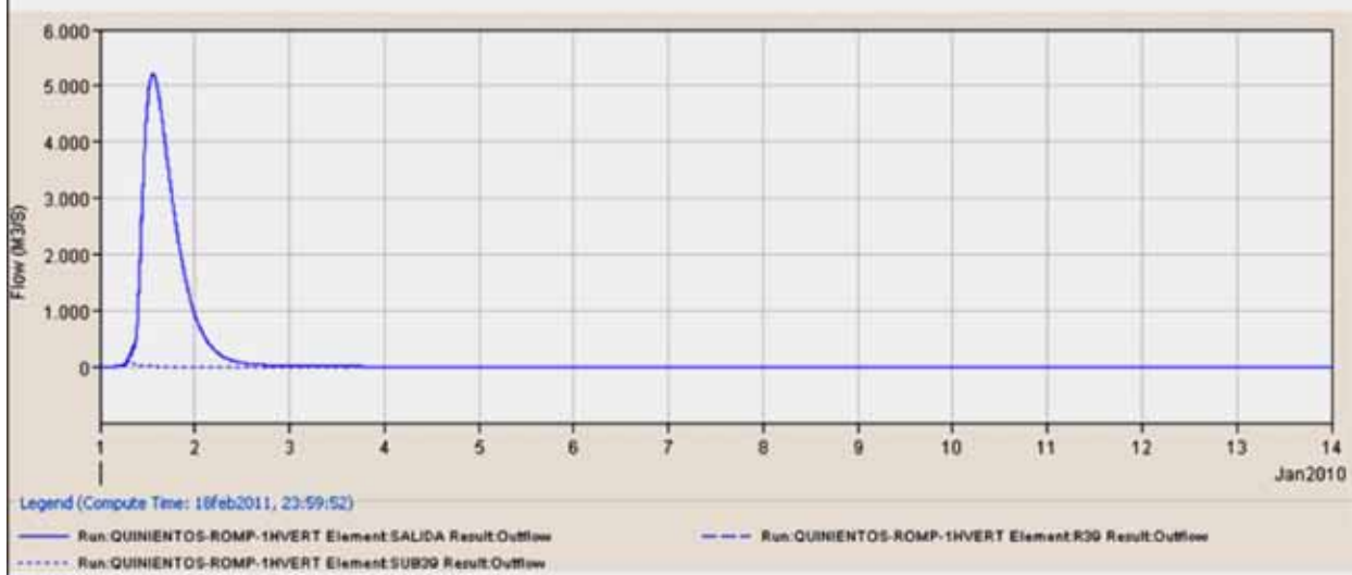
FIGURA 10. Hidrograma en la salida de la cuenca del río Coro para 500 años de período de retorno considerando la falla. de la presa del embalse “El Isiro” por vertimiento.
