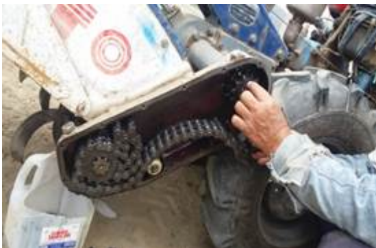
FIGURA 1. Rotura de cadena propulsora.
