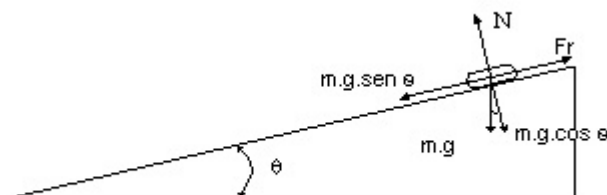
FIGURA 1. Cuerpo libre y aparato para la determinación del coeficiente de fricción. Fuente: Archivo del autor.
