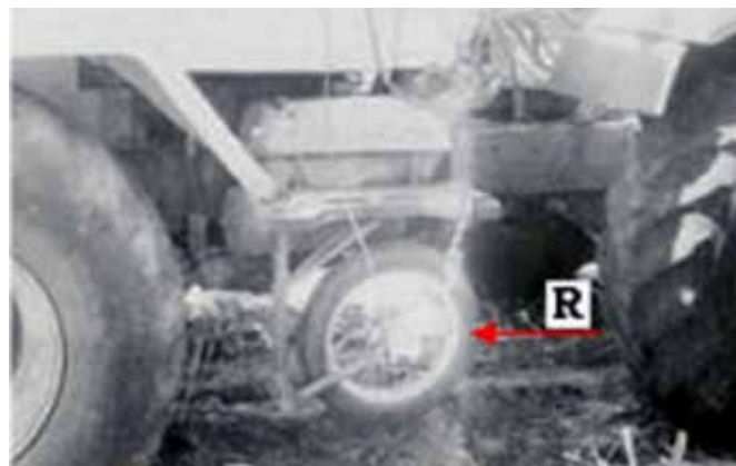
FIGURA 3. Dispositivo para medición de la velocidad. Quinta rueda (R) para la determinación de la velocidad real del apero.
