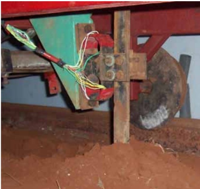
FIGURA 1. Dinamómetro de anillos extendidos empleado en la evaluación de un órgano escarificador.
