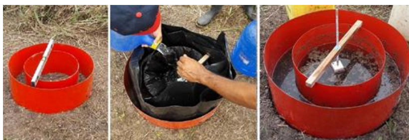
FIGURA 3. Colocación de los Anillos de Infiltración para la determinación de Velocidad de Infiltración en uno de los puntos de observación.
