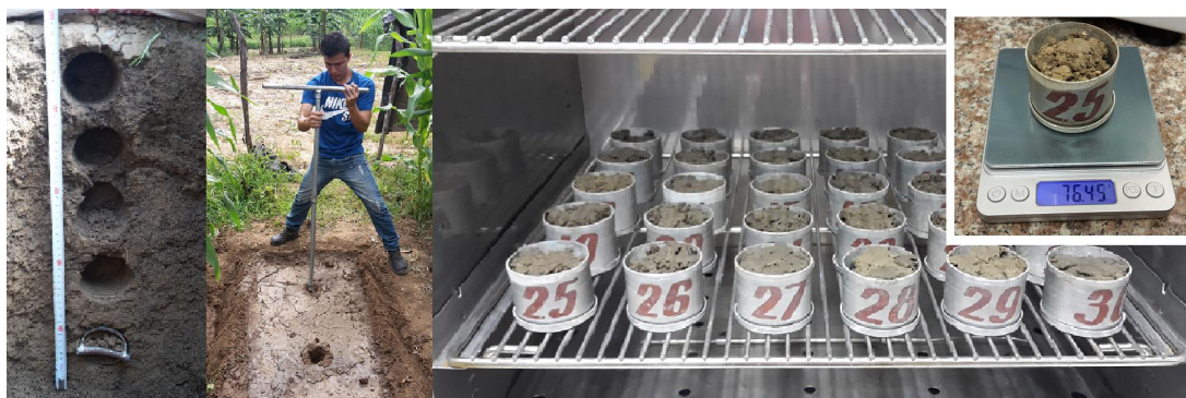
FIGURA 2. Extracción de muestras y procesamiento en el laboratorio para la determinación de la capacidad de campo, densidad real, densidad aparente y porosidad.
