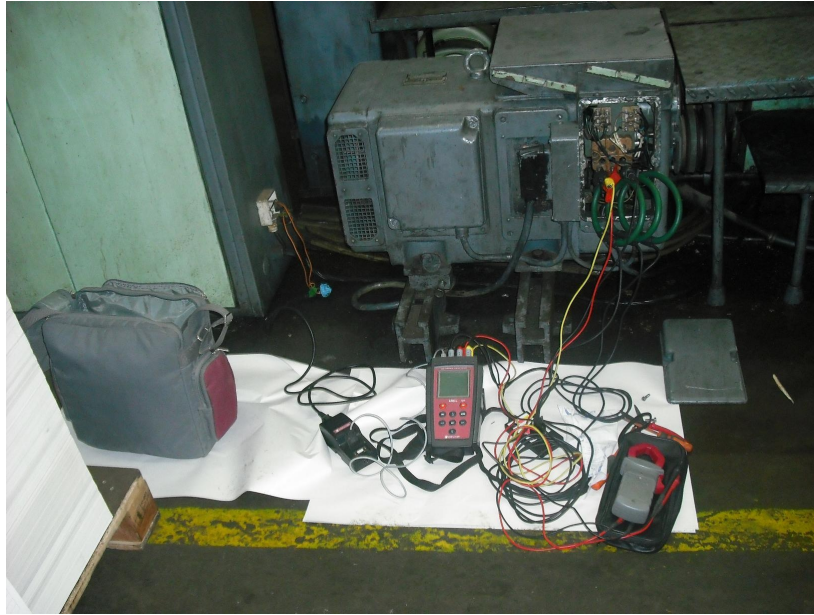
Fig. 2. Analizador de redes monitoreando datos en el accionamiento eléctrico
