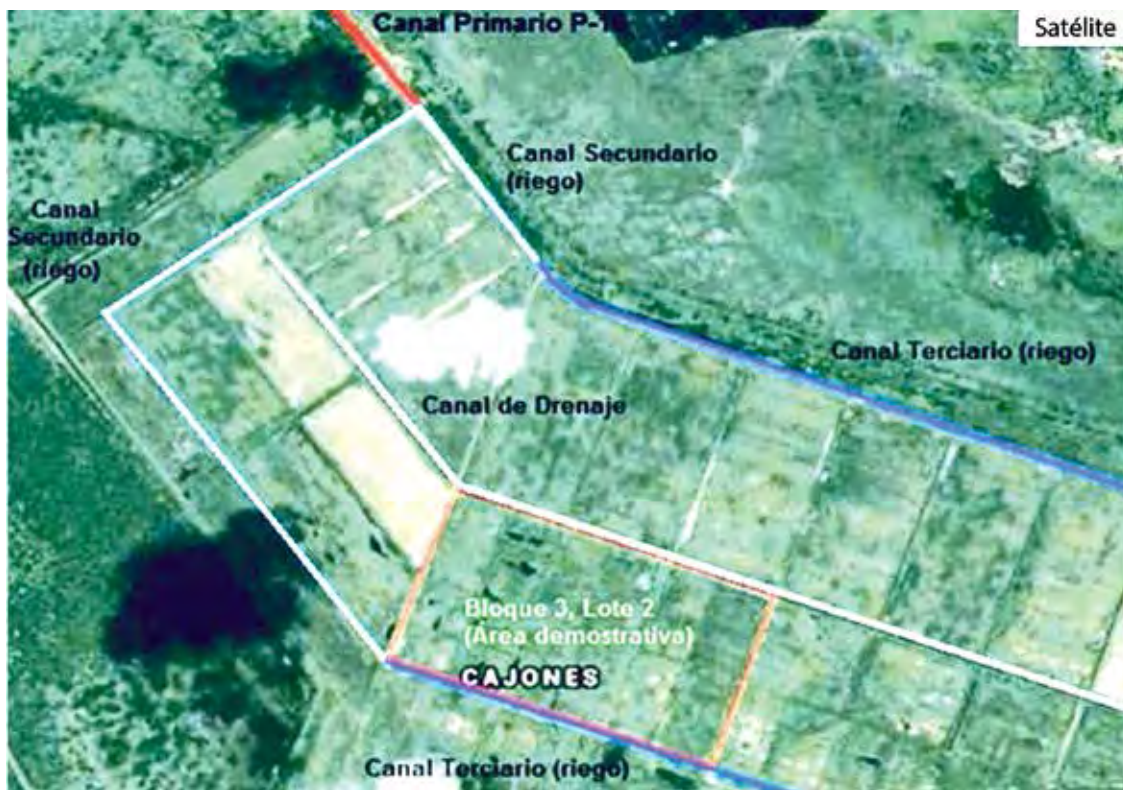
FIGURA 1. Componentes del complejo hidráulico (sistema secundario y terciario) y delimitación del área demostrativa.
