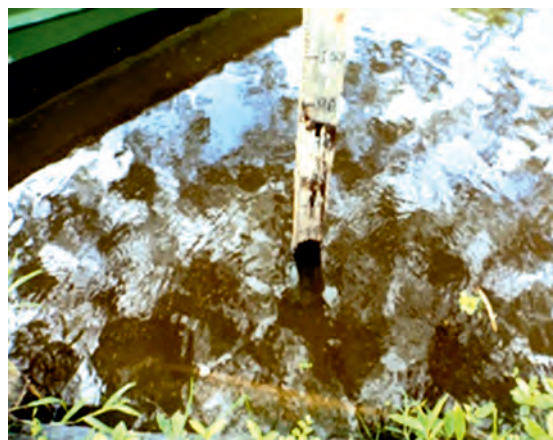
FIGURA 18. Escala para la medición de las mareas.
