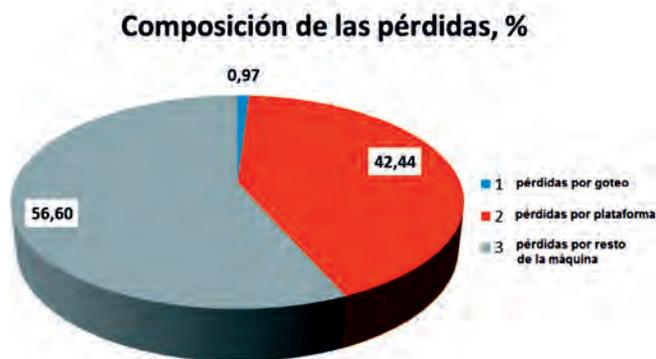
FIGURA 4. Composición de las pérdidas (%) durante la cosecha mecanizada de arroz de la variedad “Reforma” con la cosechadora CLAAS CROP TIGER-30.
